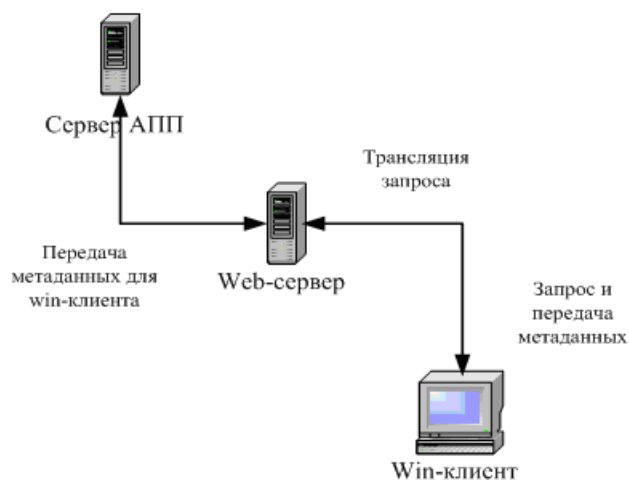
Рисунок 5 – Работа web-сервера с win-клиентом
